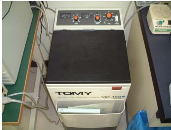
←実験で使用した遠心分離機。毎分一万数千回転という超高速で回転し、液体を遠心する。基本的に回転数が多いほど大きい音をたてるものと思われる。
